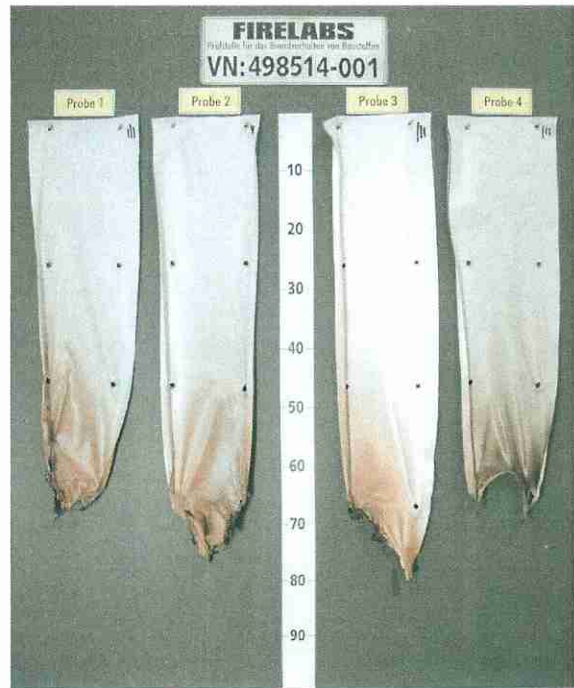
Bild 6 Aussehen des Probekörpers nach dem Brandversuch
