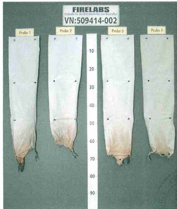
Bild 12 Aussehen des Probekörpers nach dem Brandversuch (Probe 4: Rückseite)
