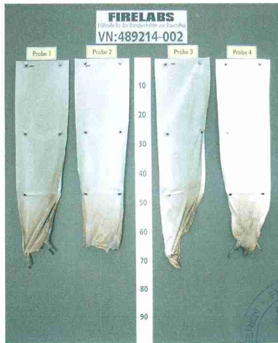
Bild 4 Aussehen des Probekörpers nach dem Brandversuch (Probe 4: Rückseite)
