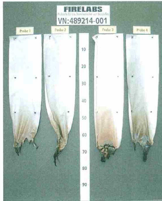
Bild 2 Aussehen des Probekörpers nach dem Brandversuch
