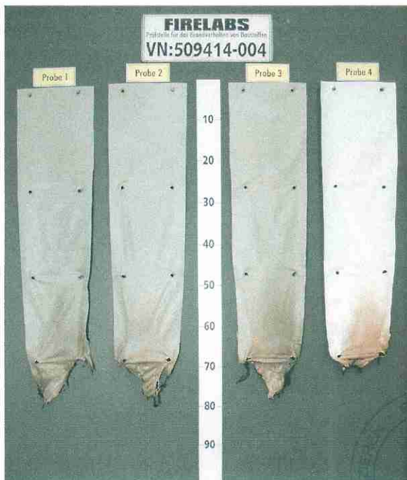
Bild 16 Aussehen des Probekörpers nach dem Brandversuch (Probe 4: Rückseite)
