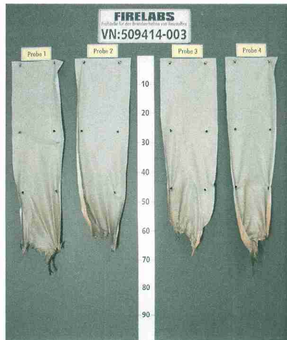
Bild 14 Aussehen der Probekörper nach dem Brandversuch
