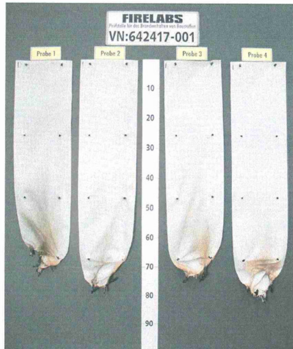
Bild 2 Aussehen des Probekörpers nach dem Brandversuch
