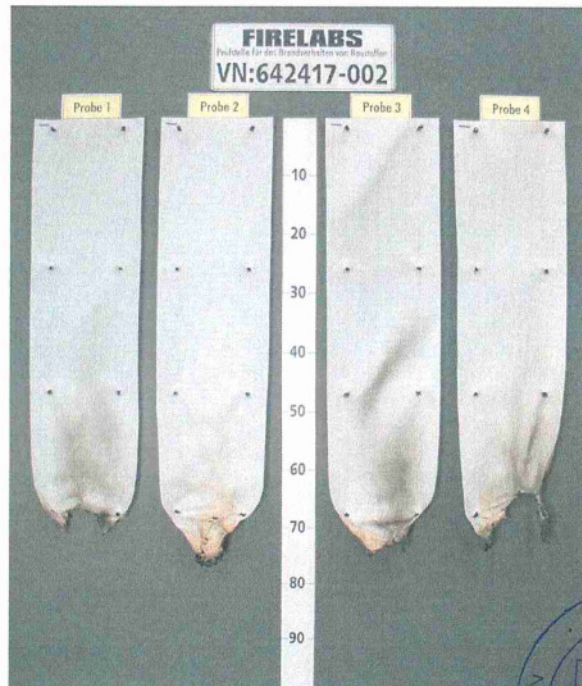
Bild 4 Aussehen des Probekörpers nach dem Brandversuch
